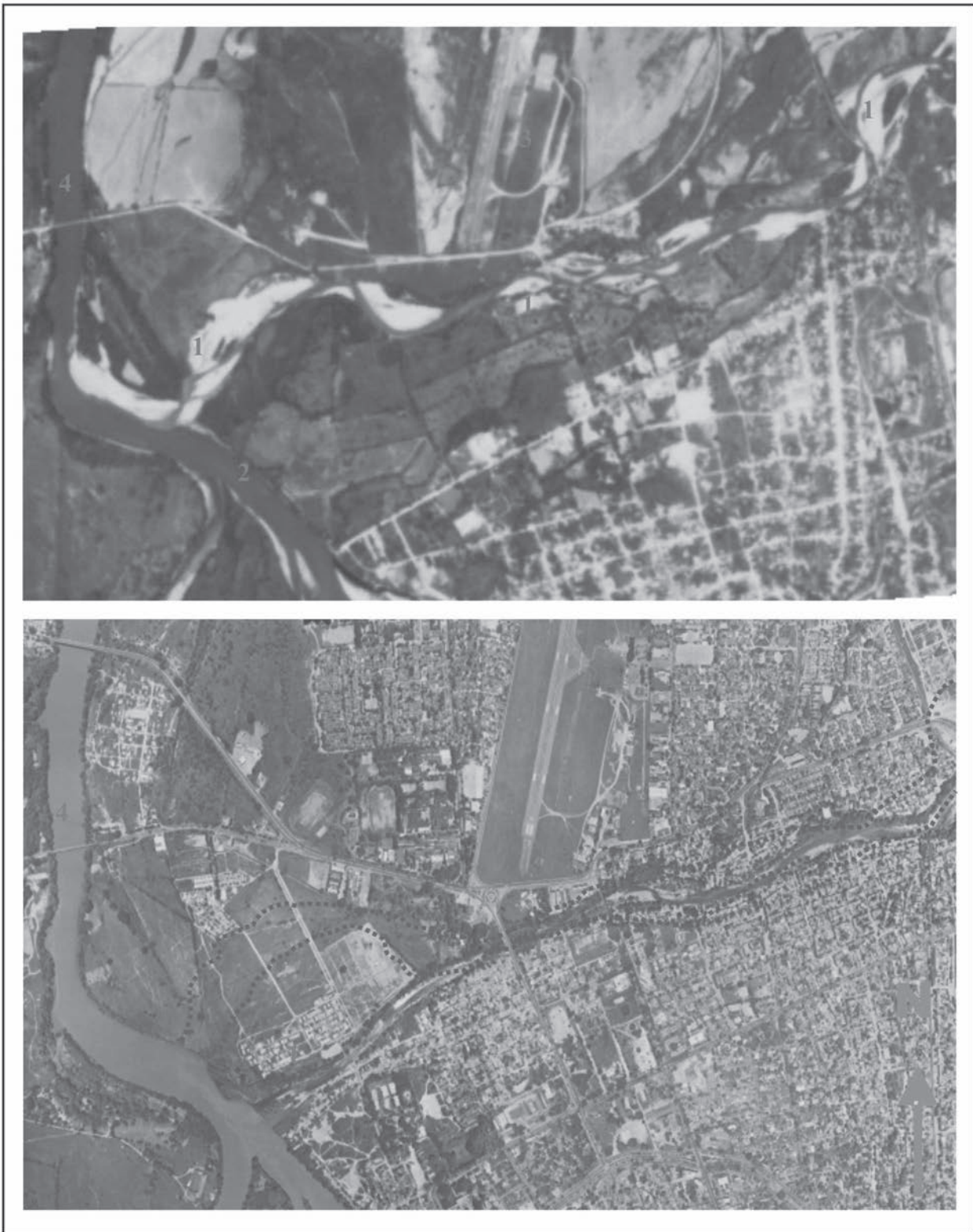
Figura 4. Fotografías aéreas multitemporales (arriba año 1957; 1993, abajo) del IGAC que demuestran la ocupación del cauce y terrazas del río Las Ceibas (1) como parte del crecimiento de Neiva (el centro en la esquina inferior derecha). En punteado el canal modificado. 2: Río Magdalena; 3: aeropuerto Benito Salas; 4: puente Santander, acceso urbano desde 1940
