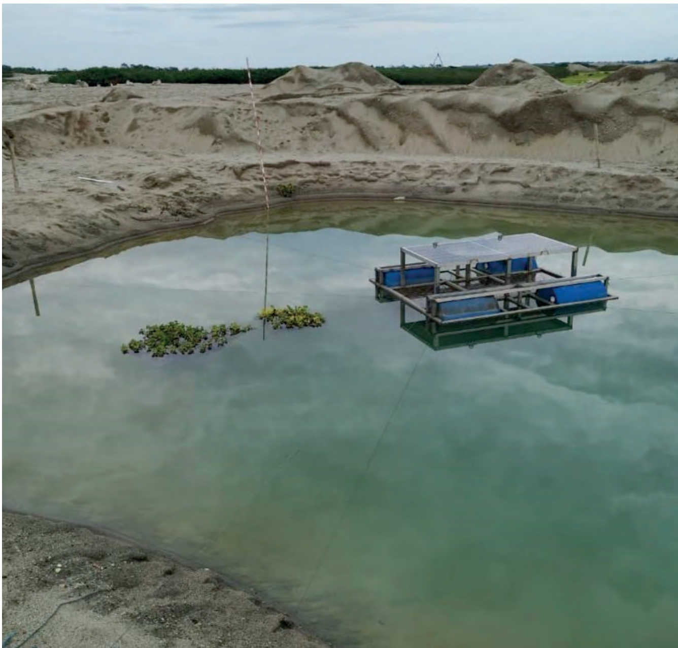
Electrofloculador solar. Diseñode De Lápices a Cohetes Fuente: Esteban González P.
