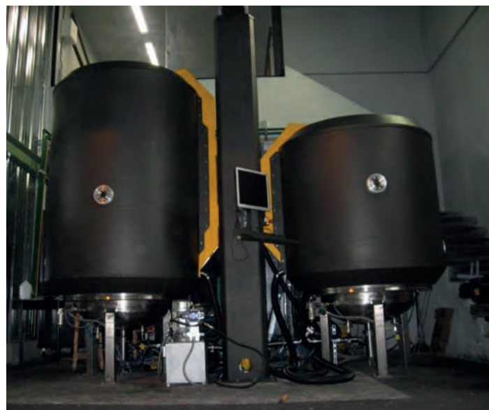
Máquina de nitruración por plasma. Diseño: De Lápices a Cohetes Fuente: Esteban González P.
