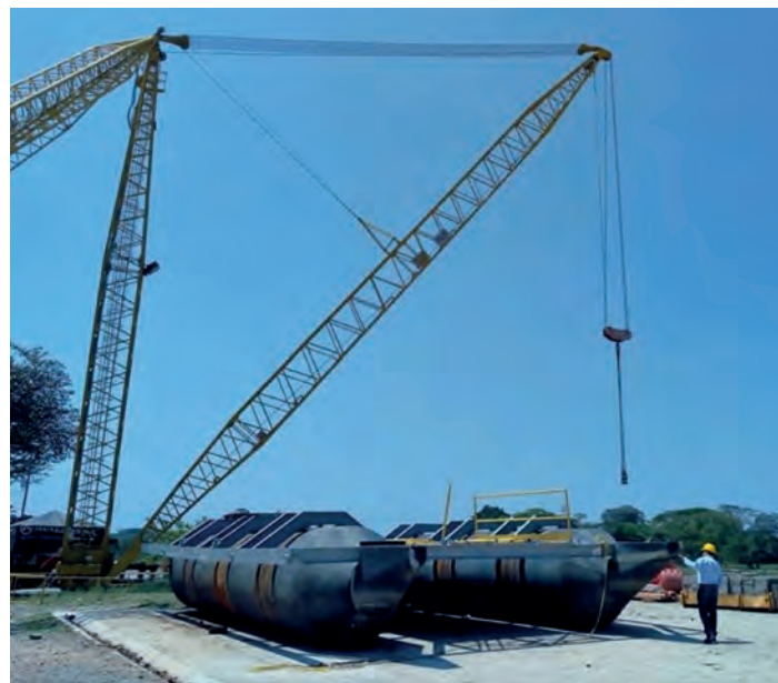
Barcaza Anfibia para cargas pesadas. Diseño: De Lápices a Cohetes Fuente: Esteban González P.
