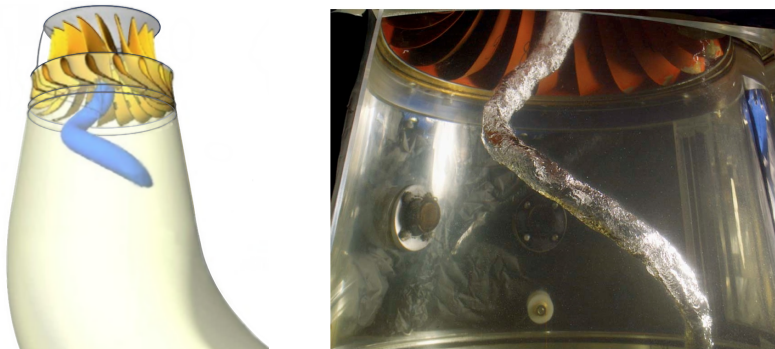
Figura 1.2 Simulación no estacionaria (izquierda) de la torcha que aparece a la salida del rotor de una turbina Francis (derecha)
