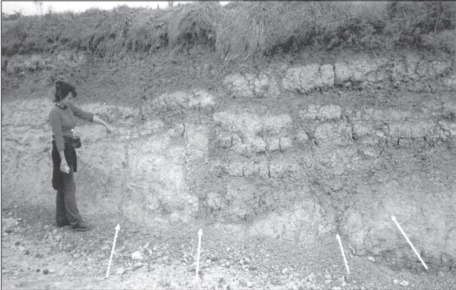
**Fig.16.7.** Fallas Geológicas en depósitos cuaternarios en el río Tunjuelo. Proyecto pre-grado U.N. Bogotá, Geociencias.
